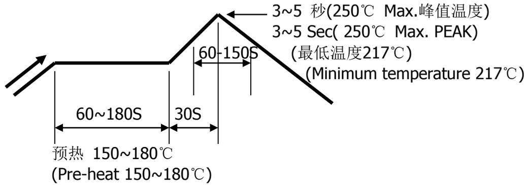
温度条件曲线图/ 基板上温度
