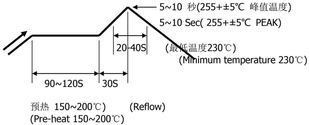
温度条件曲线图/ 基板上温度
